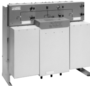
Fig. 15 : Equipement compact pour la distribution MT ; la sortie, protégée par le disjoncteur, est placée au centre (RM6 - Merlin Gerin).
